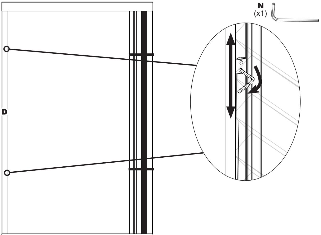
Enlevez le ruban adhésif de maintien et testez la tension des fils en ouvrant la moustiquaire. Pour régler de nouveau la tension des fils, ouvrez complètement la moustiquaire. Après réglage, clipsez l'aimant au profil.
